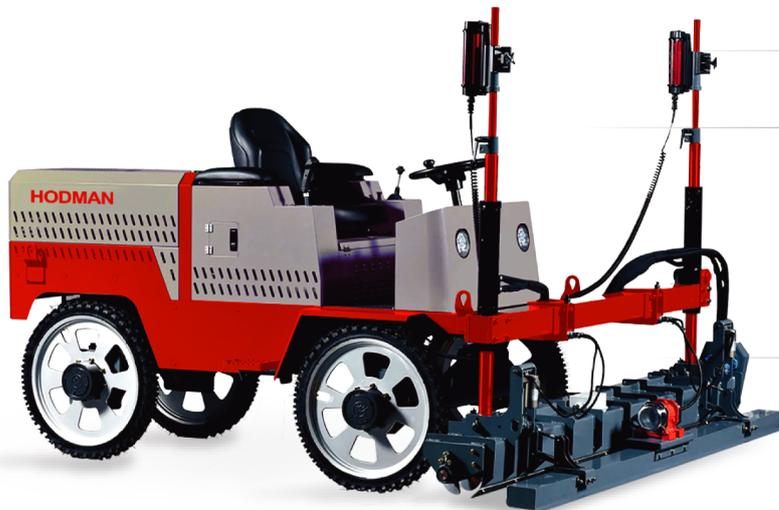
ЛАЗЕРНАЯ СИСТЕМА МОБА + LEICA (ГЕРМАНИЯ)
