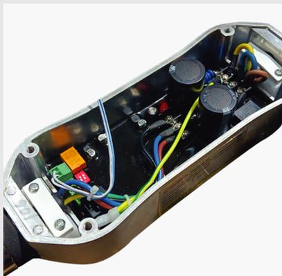
Глубинный вибратор HODMAN HF оснащен встроенным микро-датчиком, который интеллектуально регулирует мощность в зависимости от нагрузки на бетон, а его высокопроизводительный двигатель поддерживает постоянную скорость вращения 12000 об/мин для эффективного уплотнения.
